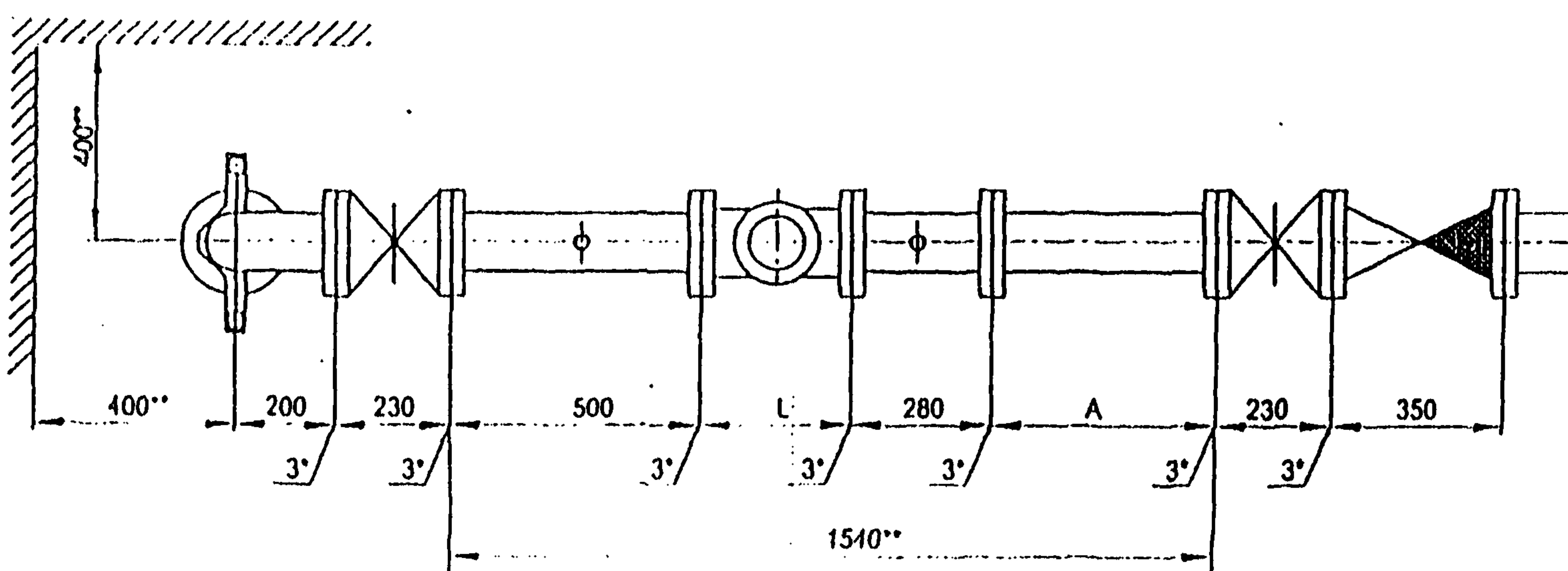
Установка счетчика  $D_y=100$  мм в подземном узле
